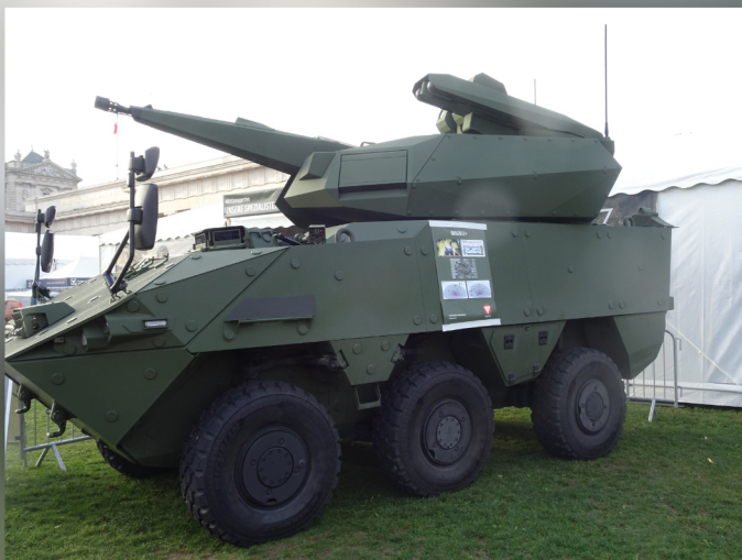
36 Pandur EVO mit Rheinmetall-Turm Skyranger 30, Flieger- und Drohnenabwehr mit 30mm Kanone und Lenkwaffe Mistral ab 2026 für das Bundesheer
